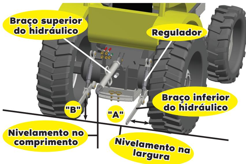
» Com o cabeçalho acoplado, faça a centralização. Para isso, siga os seguintes passos:
