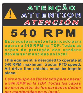
Etiqueta adesiva "Este equipamento é fabricado para operar a 540 RPM na TDP. Todas as capas de proteção dos cardans devem ser mantidas no local".
