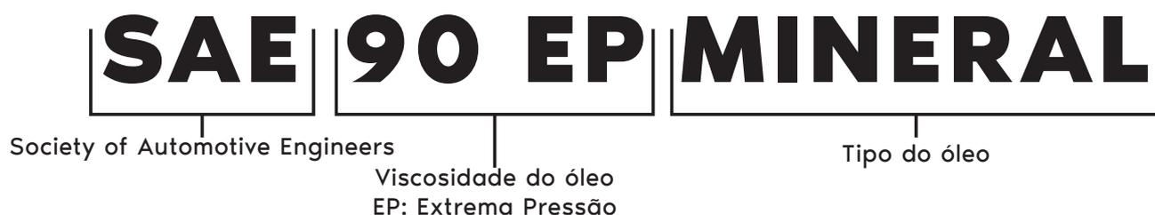
Portanto, "SAE 90 EP mineral" indica um óleo de transmissão com uma viscosidade específica de 90 de extrema pressão, derivado de fontes minerais.
